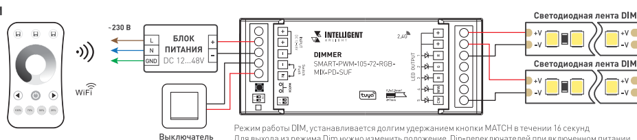
Рис. 1. Схемы подключения диммера SMART-PWM-105-72-RGB-MIX-PD-SUF
