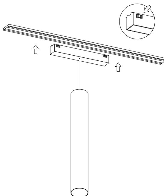
Рис. 2. Установка светильника
