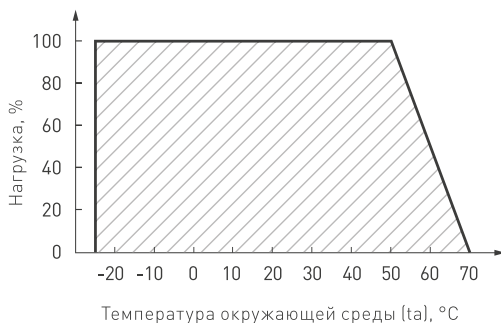
Рис. 7. Максимальная допустимая нагрузка, % от мощности источника
