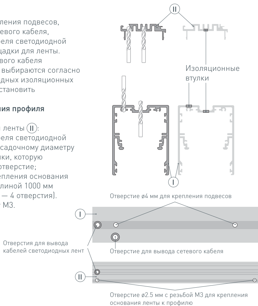
Рисунок 1. Профиль Ⓘ и основание для ленты Ⓜ , вид сверху
