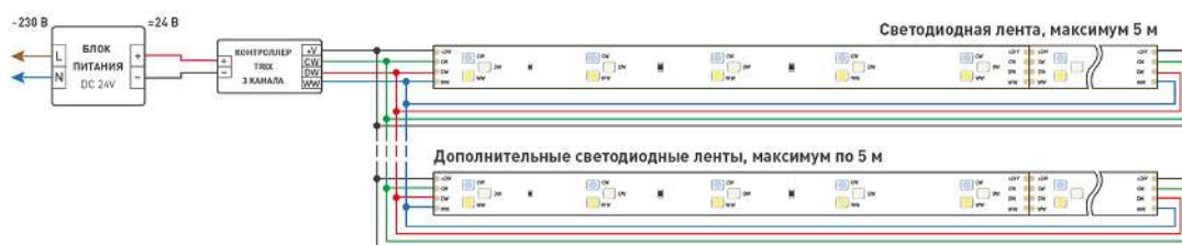
Схема 2. Подключение нескольких светодиодных лент с двух сторон. Рекомендуется использовать для обеспечения равномерного свечения ленты по всей длине.
