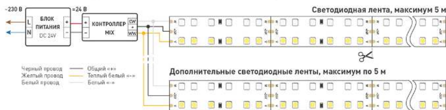
Схема 1. Подключение нескольких светодиодных лент с одной стороны.
