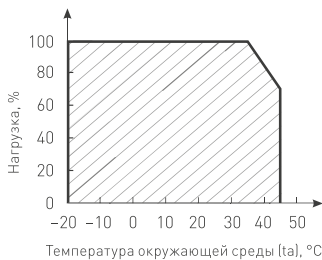
Рисунок 2. Максимальная допустимая нагрузка, % от мощности источника
