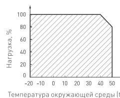
Рис. 3. Максимальная допустимая нагрузка, % от мощности источника
