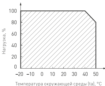
Рис. 2. Максимальная допустимая нагрузка, % от мощности источника
