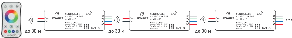
Рисунок 2. Ретрансляция сигнала от пульта ДУ (до 30 м на открытом пространстве)
