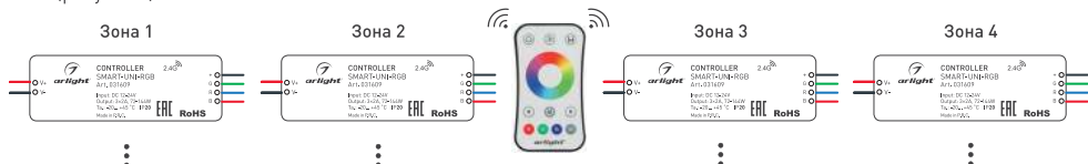
Рисунок 3. Вариант построения системы с 4-зонным пультом дистанционного управления
