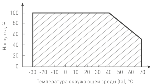
Рис. 2. Максимальная допустимая нагрузка, % от мощности источника
