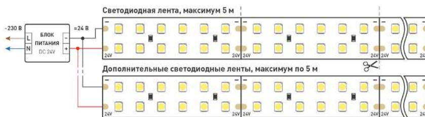
Схема 1. Подключение нескольких светодиодных лент с одной стороны.
