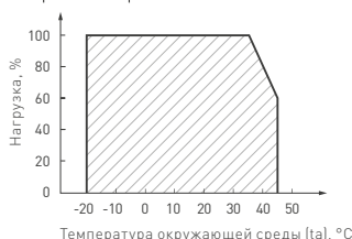
Рис. 5. Максимальная допустимая нагрузка, % от мощности источника
